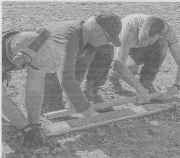
L'équipe de géologues a « carotté » jusqu'à 9 mètres de profondeur.
